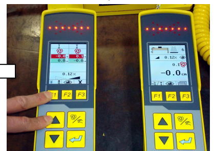
反対側のセンサをコントロール するにはF1キーを押しながら 上下キーや自動/手動キーを 操作する。
